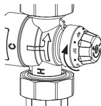
Для предотвращения нежелательного увеличения температуры на выходе термостатического клапана, например, непосредственно после старта циркуляционного насоса, байпас термостатического клапана всегда приоткрыт. Для точного и надёжного поддержания требуемой температуры, необходимо иметь разницу температур на входе и на подмесе клапана не менее 10 °С.
